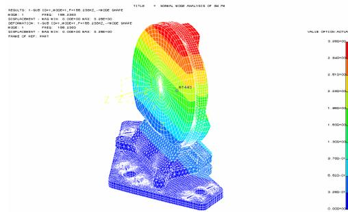
Figure 12. SWFFMA Mode 1 (164 Hz)
